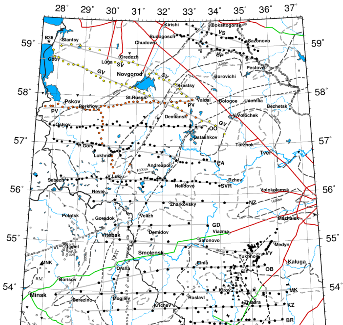
Рис. 1. Массив МТ/МВ зондирований SMOLENSK и примыкающая с ЮВ часть массива KIROVOGRAD: красные пятиугольники – синхронные зондирования 2023 г., желтые – проект на 2024 г., черные – синхронные зондирования до 2023 г., большие черные треугольники – геомагнитные обсерватории, меньшие значки – архивные локальные зондирования; пунктиры – изолинии мощности осадков, глубинные разломы [3] и границы Крестцовского авлакогена [7]; зеленые линии – ж/д на переменном токе, красные – на постоянном.
