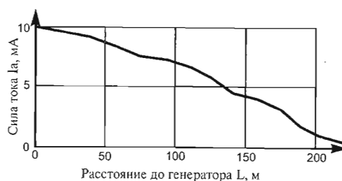
Рис. 8.3. Распределение силы тока в незаземленном, изолированном кабеле, лежащем на земле. Эксперимент выполнен во время геофизической практики в районе Александровской базы в 1997 году.
