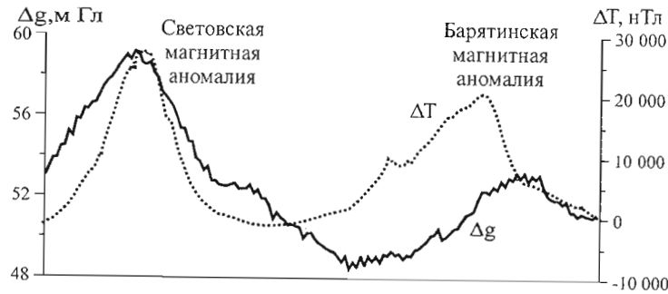
Рис. 4.4. Графики магнитного и гравитационного полей по профилю, пересекающему Барятинскую и Световскую магнитные аномалии.
