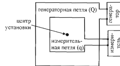
Рис. 14.2. Схема установки «петля в петле» с соосными петлями.
