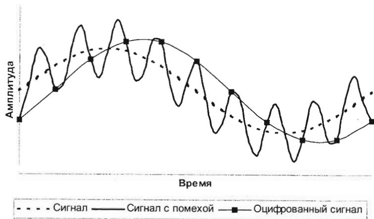
Рис. 3.25. Оцифровка входного сигнала с помехой высокой частоты при отсутствии аналоговой фильтрации.
