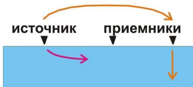
Рис. 1.9. Схема распространения ЭМ поля: оранжевые стрелки – передача по воздуху в дальнюю зону и скин-эффект в земле, малиновая – передача по земле в ближнюю зону.
