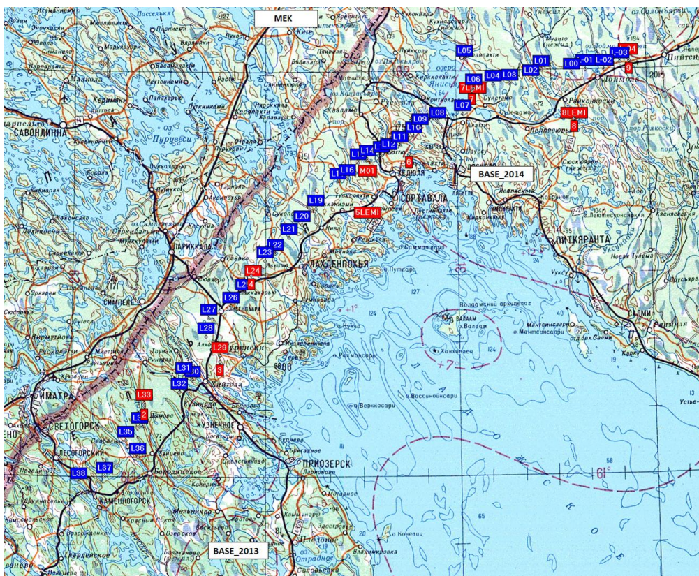
Рис. 3.5. Положение базовых пунктов непрерывных МТ наблюдений 2013 и 2014 г.г. и точек рядовых пятикомпонентных зондирований: трёхсуточных с аппаратурой LEMI-417M (красный цвет) и суточных с аппаратурой MTU-5 (красный цвет для точек, данные которых объединялись с данными трёхсуточных зондирований и синий для остальных) [Голубцова и др., 2016а; Соколова и др., 2016а].
